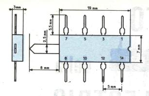
Fig. 1 Nel disegno abbiamo stilizzato il PA237 visto di prospetto e di taglio. Le dimensioni sono quelle naturali e si possono riassumere in mm 19 imes 7 per la base ed in mm. 3 per l'altezza.
