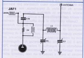
Lo stadio finale, puó essere modificato con un filtro a Pi-Greco come visibile in disegno. cedentemente, questo amplificatore lineare serve per qualsiasi gamma radiantistica, ovviamente previo adattamento della bobina di sintonia adatta per la frequenza prescelta.
