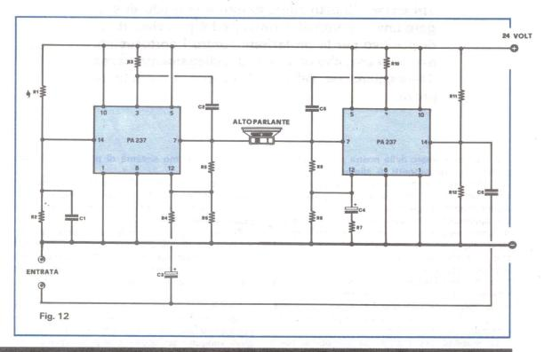
680.000 ohm R11 = 680.000 ohm R2 56.000 ohm 56.000 ohm R3 18.000 ohm C1 = 2.200 ohmR4 6.800ohm = 2.200 ohm R5 330.000 ohm 5 microF. 12 V/I elettrol. **C3** 56.000 ohm C4 = 5 microF. 12 V/I elettrol. ohm C5 = 2.200 pF56.000 ohm C6 = 220.000 pF330.000 ohm Altoparlante da 16 ohm 18.000 ohm Alimentazione 24 volt
