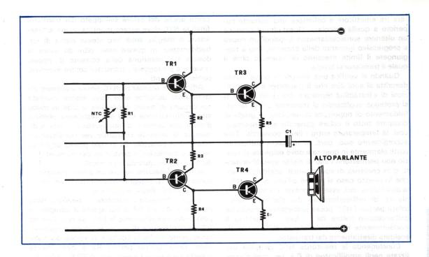
corrente di riposo dei transistor rimane sempre costante. Infatti un eventuale aumento della temperatura comporterebbe un analogo aumento della corrente di riposo dei transistor, per le caratteristiche intrinseche dei transistor stessi; d'altra parte la resistenza NTC diminuisce contemporaneamente di valore tendendo, così, a ridurre la corrente dei transistor: il risultato è che la corrente di riposo di TR1 e TR2 rimane costante anche sotto sensibili cambiamenti della temperatura.
