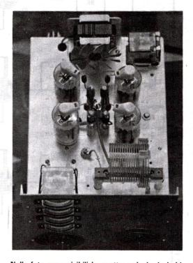
Nella foto sono visibili le quattro valvole, le bobine di accordo L1-L2 ed il ventilatore necessario per raffreddare le valvole durante il loro funzionamento.
