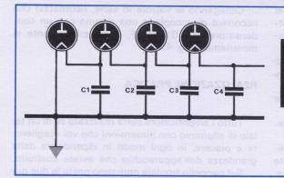
I filamenti delle quattro valvole saranno alimentati in serie come spiegato nell'articolo e dissaccopiati tramite quattro condensatori da 10.000 pF. come visibile in disegno.
