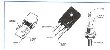
Fig.10 Poiché i diodi controllati possono presentarsi su forme e dimensioni diverse vi presentiamo in questo disegno i tipi più facilmente reperibili. Da questo stesso disegno potrete identificare i tre terminali Catodo-Anodo-Porta. Ricordarsi che i diodi SCR debbono assolutamente essere montati sopra ad alette di raffreddamento affinché non si riscaldino in modo eccessivo.
