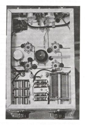
Nella parte sottostante al telaio troveranno posto oltre alla impedenza JAF1, anche i due condensatori di accordo C6 e C7, si noterà come per C7 si sia impiegato in questo prototipo un condensatore ad aria a 3 sezioni per riuscire ad ottenere i 1.000 pF. richiesti; per realizzare questo lineare si sono impiegate valvole per la deflessione orizzontale dei televisori.
