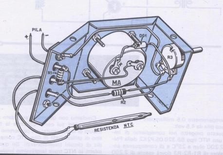
Ecco come puó essere realizzato un termometro che utilizza il sistema a ponte proposto in fig. 7. Tutto il circuito va racchiuso dentro una scatola metallica di dimensioni sufficienti a contenere anche la pila di alimentazione e lo strumentino indicatore.
