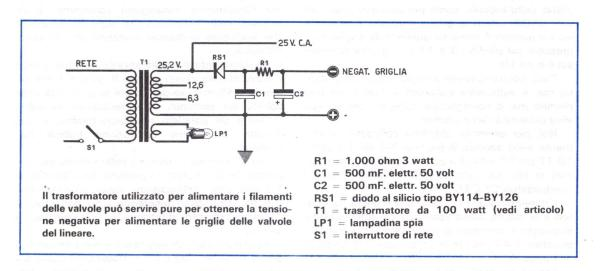
come vedesi in fig. 3, secondo percne, assorbendo ogni valvola 2,8 ampere su 6,3 volt se queste fossero alimentate in parallelo, sarebbe necessario impiegare un trasformatore in grado di erogare 12 ampere su 6,3 volt, rendendo così problematico l'avvolgimento dato l'enorme diametro del filo necessario per sopportare una tale intensità di corrente.
