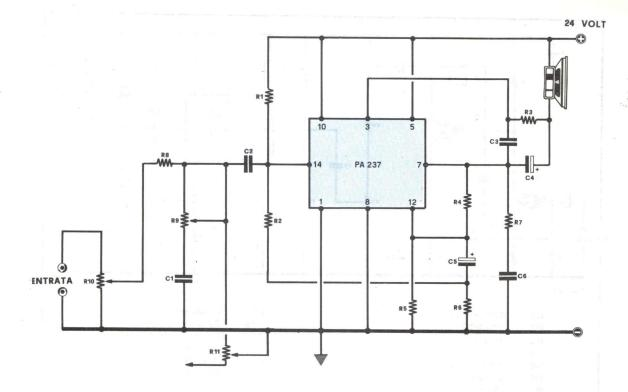
La fig. 4 mostra invece un circuito da impiegare quando si richiede una maggior sensibilità in ingresso. In questo caso è sufficiente inserire in entrata un segnale di appena 5 millivolt,per ottenere i 2 Watt in uscita: questo schema quindi si presta per le testine magnetiche che così si possono collegare direttamente all'amplificatore senza bisogno di stadi intermedi preamplificatori.
