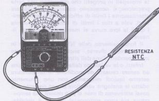
Fig. 6 In figura è illustrato il metodo più semplice per misurare una temperatura. Una resistenza NTC viene utilizzata in connubio con un normale tester predisposto per la misura di resistenza con fondo scala ohm × 1. Mettendo in contatto la NTC col corpo di cui si vuole misurare la temperatura noteremo un subitaneo abbassamento del valore resistivo segnato dall'indice del tester e da questo potremo risalire alla temperatura incognita.
