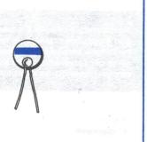
Fig. 5 II tipo a disco è senza dubbio quello che interessa maggiormente i nostri lettori in quanto è quello più usato nei normali circuiti transistorizzati. La gamma dei valori disponibili di questo tipo di NTC va da pochi ohm fino a 4.700 ohm.
