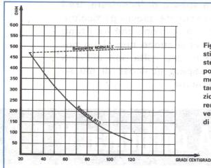
Fig. 1 In figura appare riportato il grafico caratteristico di funzionamento dei due diversi tipi di resistenze in cui la linea continua sta ad indicare il comportamento di una NTC in dipesa della temperatura mentre la linea tratteggiata simboleggia il comportamento di una resistenza normale alla stessa variazione di temperatura. Come potete notare, la differenza appare sostanziale, e non solamente come verso di curvatura delle due, ma anche come raggio di curvatura.
