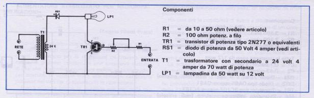
Il valore di R1 puó variare in funzione della potenza dell'amplificatore, alla cui uscita si collega l'entrata di questo apparecchio, ed in rapporto all'impedenza d'uscita.
