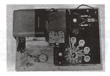
Ecco come può essere disposto sul pannello frontale della scatola tutti i componenti relativi all'oscillatore modulato. Si noterà in centro il condensatore variabile, a sinistra il portapile, mentre sulla destra il commutatore con le relative bobine.
