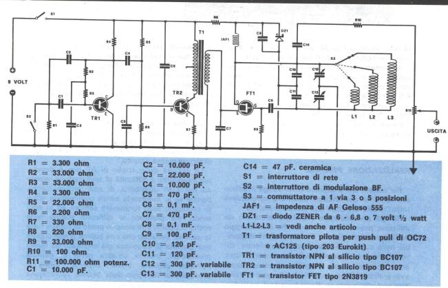
stesse caratteristiche) ed è utilizzato come oscillatore di AF in un circuito Colpitts il quale benché abbia lo svantaggio di richiedere come condensatore di sintonia un variabile a doppia sezione, presenta peró il pregio di non richiedere bobine speciali provviste di prese intermedie.
