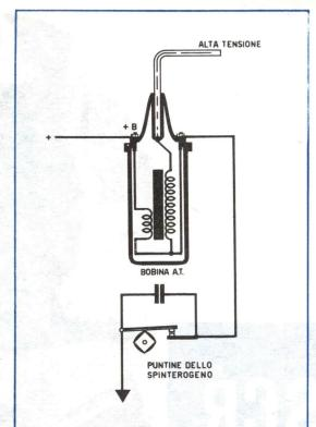
Fig. 1 Un'impianto di accensione standard è costituito da una bobina AT sul cui primario viene fatta scorrere la tensione continua della batteria. Questa tensione, interrotta dalla puntina dello spinterogeno, crea sull'avvolgimento primario della bobina una estratensione e, per induzione sull'avvolgimento secondario, composto da un numero elevato di spire, saranno disponibili i 30.000 volt circa necessari per produrre la scintilla tra gli elettrodi della candela.
