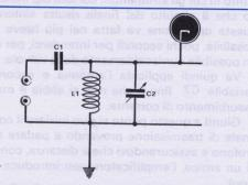
Lo stadio d'entrata del trasmettitore se viene utilizzata per una sola gamma puó essere modificata come indicato in disegno, cioè applicando in sostituzione della impedenza JAF1, una bobina L1 ed un condensatore variabile C2 adatta ad accordarsi sulla gamma prescelta.
