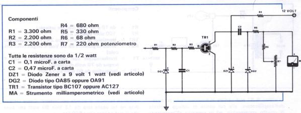
della batteria a 6 volt, di cambiare solamente il valore di due componenti, e precisamente quello del diodo Zener che, inizialmente da 9 volt, verrà sostituito da uno di 5 volt, e quello dello strumento che da 0,1 milliampere fondo scala dovrà essere sostituito da uno da 500 microampere fondo scala.
